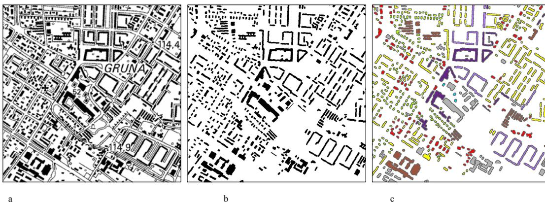
Abbildung 1: a) Grundrisslayer der DTK25-V, b) Ergebnis der Gebäudeselektion, c) Ergebnis der Gebäudeklassifikation am Beispiel Dresden-Grüna (Legende: s. Abb. 5)
