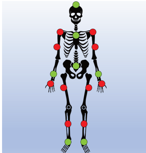
Abbildung 1: Verwendete Sensoren (grün) und nicht verwendete Sensoren für das motion-tracking (Eigene Abbildung, basierend auf Menacci, 2019)
