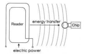
Fig. 2: Transmission passive RFID-tag
